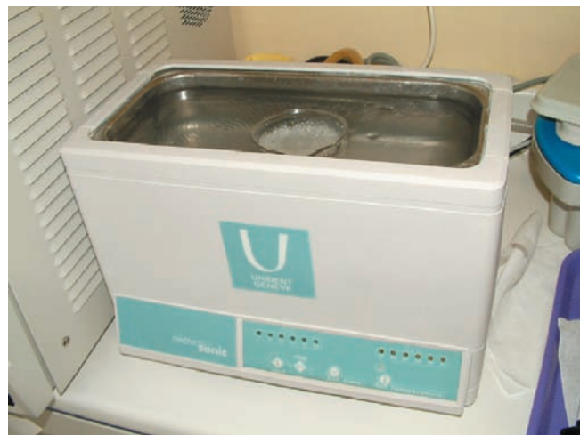
Εικόνα 27. Η απολύμανση των μηχανημάτων πρέπει να αποτελεί κανόνα πριν από την εφαρμογή τους στο στόμα των ασθενών. Αυτή πρέπει να περιλαμβάνει αρχικά την εμβάπτισή τους σε υδατόλουτρο υπερήχων και στη συνέχεια την έκθεσή τους σε κατάλληλης συγκέντρωσης απολυμαντικό διάλυμα.
